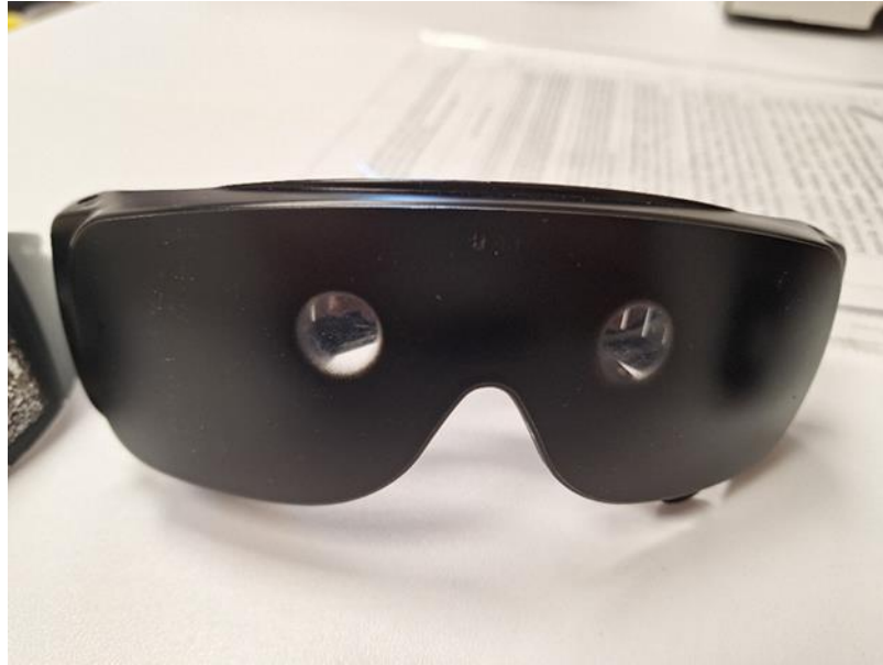
Slika 6 Simulacijske naočale sa suženjem vidnog polja i smanjenom oštrinom
