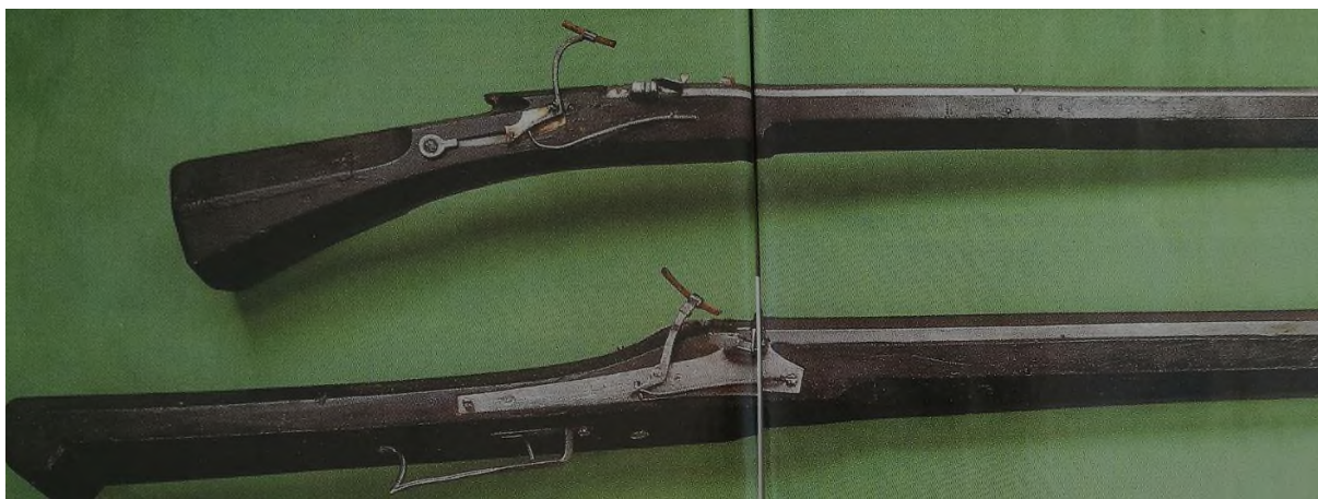
Slika 7.: dvije tvrđavske puške s mehanizmom na serpentinu. Štajerska izrada, sredina 16.st. Oružarnica u Grazu, inv.br, G 156 i G137 56
