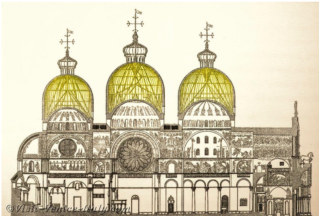
Slika 20: Bazilika sv. Marka do početka 13. stoljeća - tlocrtni presjek kupola - drvena struktura
