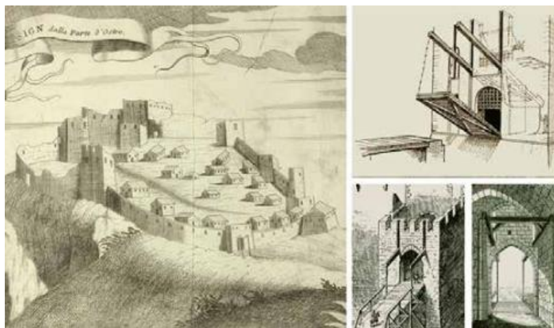
Slika 24. Ulazna kula s pokretnim mostom na zapadnom bedemu Starog Grada na Coronellijevoj veduti i mogući izgled sistema za podizanje mosta
