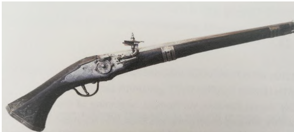
Slika 8.: Časnički pištolj s mehanizmom na kolo. Proizvodnja Ferlach oko 1600.god. Mehanizam na kolo s vanjskim kotačem ukrašen gravurama. Zbirka Brkić. 57
