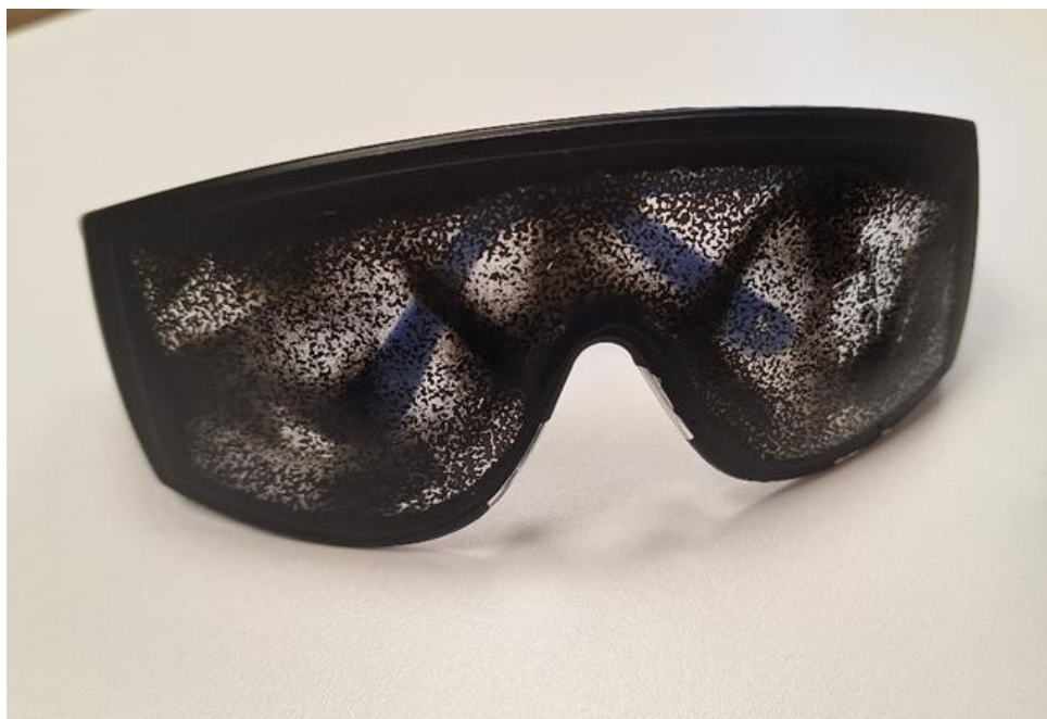
Slika 5 Simulacijske naočale sa smanjenom oštrinom
